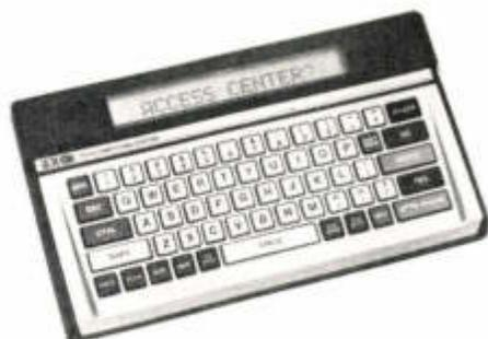
fois à la NCC. C'est l'appareil « tout-en-un » comportant un clavier, un écran d'une ligne à cristaux liquides et un modem téléphonique intégré, le tout de la dimension d'une grosse tablette de chocolat.
